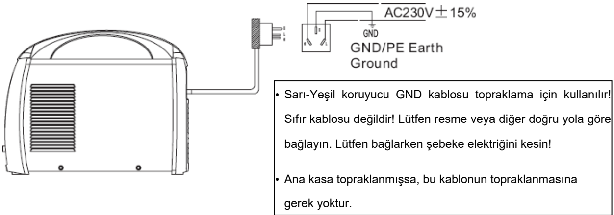
Şek. 4-9-1: Giriş güç kaynağı kablosu ile anahtar kutusu arasındaki bağlantı
